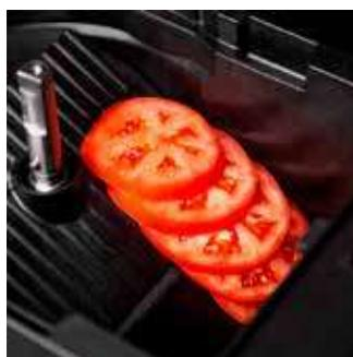
Linea Compact: Gravity slide system - fornito di rampa per l'espellimento del prodotto per gravità.
