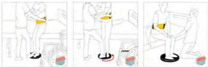
Ausilio dalla base rigida e girevole consente i trasferimenti in piedi di utenti in carrozzina o con problemi alle articolazioni inferiori. Per trasferimenti da carrozzina a letto, da poltrone, sedie e wc a carrozzina o viceversa. I piedini antiscivolo gialli sulla base inferiore del disco ne garantiscono la sicurezza favorendo l'aderenza al pavimento. L'utilizzo di questo supporto avviene con l'aiuto di un assistente ed è possibile in ogni ambiente domestico.
