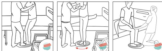
Piano circolare girevole per i trasferimenti in sicurezza di utenti con limitazioni alla capacità di movimento, sgravando l'assistente da sforzi eccessivi. Presenta una superficie antiscivolo riprodotta anche nella base inferiore per fornire il massimo del grip durante il trasferimento, per la stabilità dell'utente, favorita da una rotazione controllata e del supporto. Leggero e poco ingombrante. Presenta una piccola estensione, un'asola per sollevarlo da terra.
