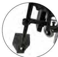
La pedana della carrozzina può essere tolta per agevolare l'accesso e la discesa dalla carrozzina. Con la pedana vi è anche un poggia polpaccio regolabile in altezza ed inclinazione.
