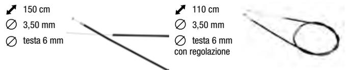
Cavi per azionamento dei freni di deambulatori, realizzati in acciaio inossidabile, disponibili in due differenti versioni: lunghezza 150 cm e lunghezza 110 cm con vite per regolazione.
