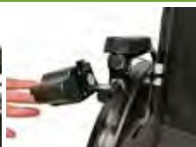
In combinazione al morsetto di serie, permette di fissare il joystick sotto il bracciolo o sul telaio frontale della carrozzina nella posizione più congeniale per l'utente.
