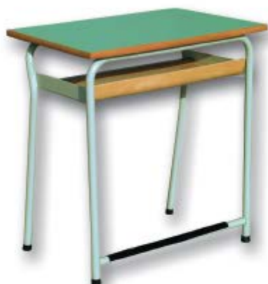
Art. GF 180 - Banco Monoposto sottopiano in faggio pressocurvato con poggiatesta. Struttura in tubolare 25x1.5, e piastre ad angolo di collegamento, piano di scrittura in conglomerato ligneo mm 20. Bordatura in massello di faggio arrotondato, poggiatesta ricoperto con profilo in PVC rigato, puntali antirumore alla base della struttura.
