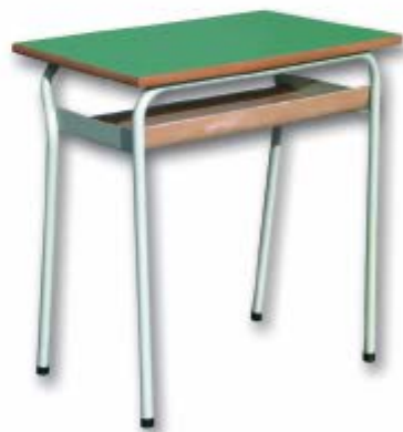
Art. GF 170 - Banco Monoposto sottopiano in faggio pressocurvato. Struttura in tubolare 25x1.5. e piastre ad angolo di collegamento. Piano di scrittura in conglomerato ligneo mm 20, bordatura in massello di faggio arrotondato. Puntali antirumore alla base della struttura.
