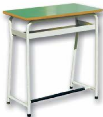
Art. GF 100 - Banco Monoposto sottopiano in lamiera con poggiatesta ancorato alle quattro gambe. Struttura in tubolare 25x1.5, piano di scrittura in conglomerato ligneo mm 20. Bordatura in massello di faggio arrotondato, poggiatesta ricoperto con profilo in PVC rigato, puntali antirumore alla base della struttura
