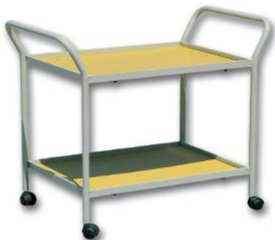
Art. GF 1370 - Carrello portavivande. Struttura in tubolare di acciaio diametro 28. verniciata a caldo su ruote piroettanti. Ripiani superiore e inferiore in formica. Dimensione 100x50xH90.
