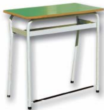
Art. GF 120 - Banco Monoposto sottopiano in lamiera con poggiatesta. Struttura in tubolare 25x1.5, piano di scrittura in conglomerato ligneo mm 20. Bordatura in massello di faggio arrotondato, poggiatesta ricoperto con profilo in PVC rigato, puntali antirumore alla base della struttura
