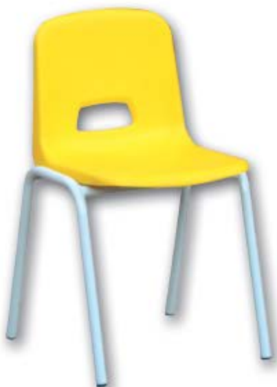
Art. GF 1020 - Sediolina sovrapponibile unica scocca in polipropilene. Struttura in tubolare 18x1,2. Sedute e spalliera in unica scocca in polipropilene. Alla base puntali alettati antirumore.
