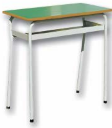
Art. GF 110 - Banco Monoposto sottopiano in lamiera Struttura in tubolare 25x1.5, piano di scrittura in conglomerato ligneo mm 20. Bordatura in massello di faggio arrotondato, puntali antirumore alla base della struttura
