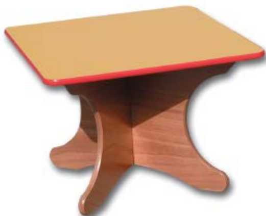
Art. GF 920 - Tavolinetto Quadrato Struttura portante in multistrato verniciato al naturale. Piano in conglomerato ligneo spessore mm 18. Bordature perimetrale in gomma antiurto arrotondata. Dimensione cm 70x70x52H.
