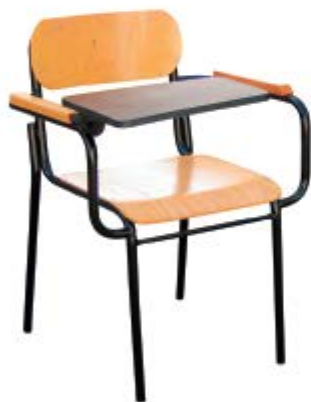
Art. GF 510 - Poltroncina con mensola Struttura in tubolare 22x1.2, saldata a filo continuo 40x40. Collegamenti di sostegno e rinforzo della struttura aderenti al di sotto del sedile. Il sedile e la spalliera da cm 35x35 - 40x40 in faggio sono fissati alla struttura tramite rivetti. Braccioli ricoperti in massello di faggio completa di mensola snodabile in plastica. Alla base puntali alettati antirumore.
