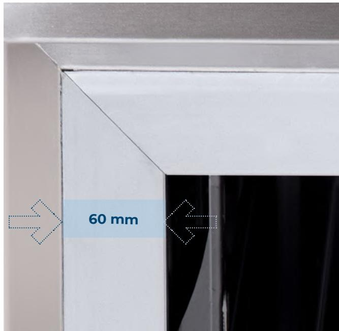
La struttura è realizzata in **acciaio Inox AISI 304** con gli angoli interni arrotondati; lo **spessore di isolamento di 60 mm** è in poliuretano espanso ad alta densità senza CFC e HCFC.
